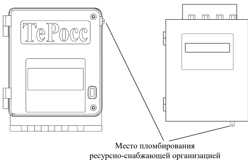
Рисунок 2б – Схема пломбировки от несанкционированного доступа, обозначение места нанесения знака пломбировки на вычислительный блок TePocc-ВУ ресурсно-снабжающей организацией
