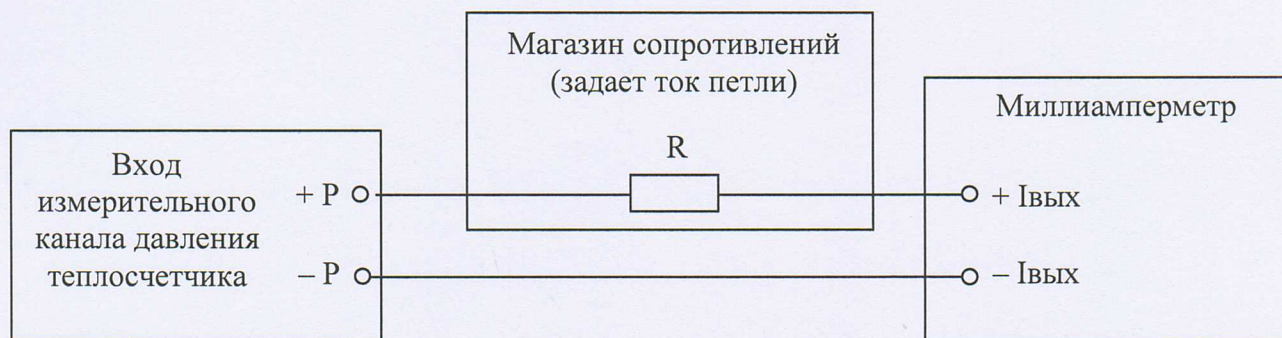
Рисунок Б.5 – Электрическая схема подключения эталонного СИ при поверке измерительного канала давления теплосчетчика при использовании магазина сопротивлений и миллиамперметра.
